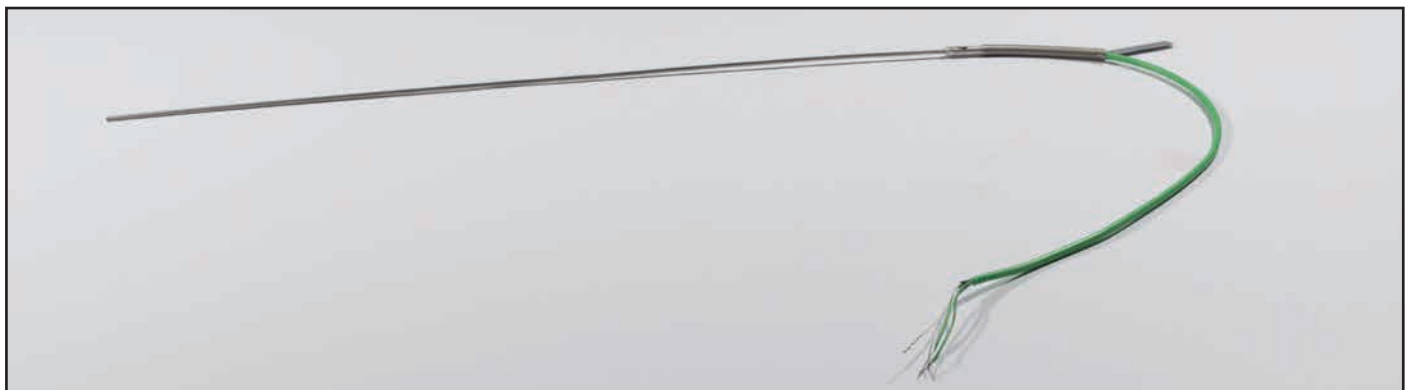
Mantelthermoelement, Ø3,0 mm, Mantelwerkstoff Inconel (2.4816) , Ausführung D
